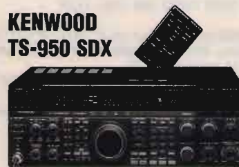
Ricetrasmittitore HF. 150 W - Finale a MOSFET
