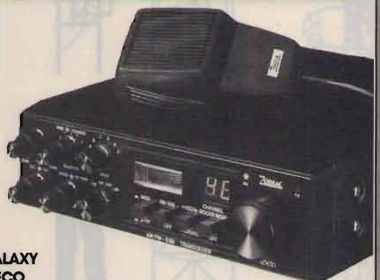
ZODIAC TOKIO Ricetrasmittitore CB 27 MHz, 271 ch. AM/FM/SSB, 25 W potenza regolabile Roger, Beep e Echo incorporati L. 335.000 IVA COMPRESA
